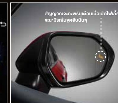
◀ Blind Spot Monitor ระบบช่วยเตือนมุมอับสายตาที่ระจกมองข้าง
